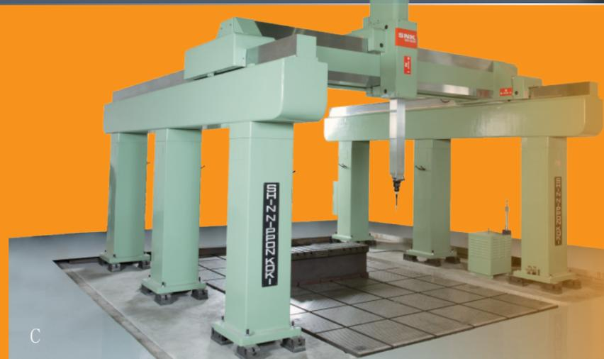
**硬軌** 機種為了達成及確保機械的長期剛性與精度，鑄件須經長期自然消除應力，而後採用SNK五面加工機做一二次精密加工，再使用大型三次元量測儀器做精密檢驗，所有主件皆採用米漢納鑄鐵、高剛性鑄件材質，吸震效果絕佳、耐磨性特強，每一座能提供製造硬軌基座之結構體，皆是經千錘百鍊方能成就。
